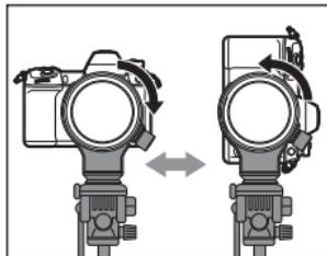
**3** 按照箭头所示方向转动三脚架台座锁定旋钮将其牢牢拧紧。
