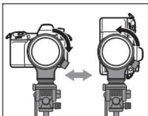
**3** Tournez le bouton de verrouillage de la monture pour trépied dans le sens de la flèche pour le serrer fermement.
