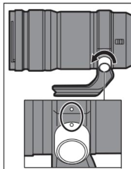
**2** 对准三脚架台座和三脚架台座锁定旋钮上的标记。
