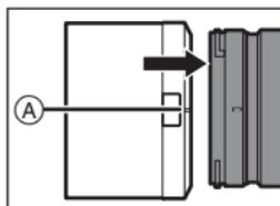
**2 Faites tourner le parasoleil dans le sens de la flèche pour aligner le repère Ⓑ (○) présent sur le parasoleil sur le repère situé à l'extrémité de l'objectif.**
