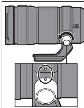
**2** Faites correspondre les repères présents sur la monture pour trépied et sur le bouton de verrouillage de la monture pour trépied.
