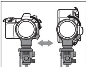
**3** Drehen Sie den Verriegelungsknopf der Stativhalterung in Pfeilrichtung, um ihn kräftig festzuziehen.
