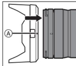
2 Gire el parasol en la dirección de la flecha para alinear la marca (B) (○) del parasol con la marca en el extremo de la lente.
